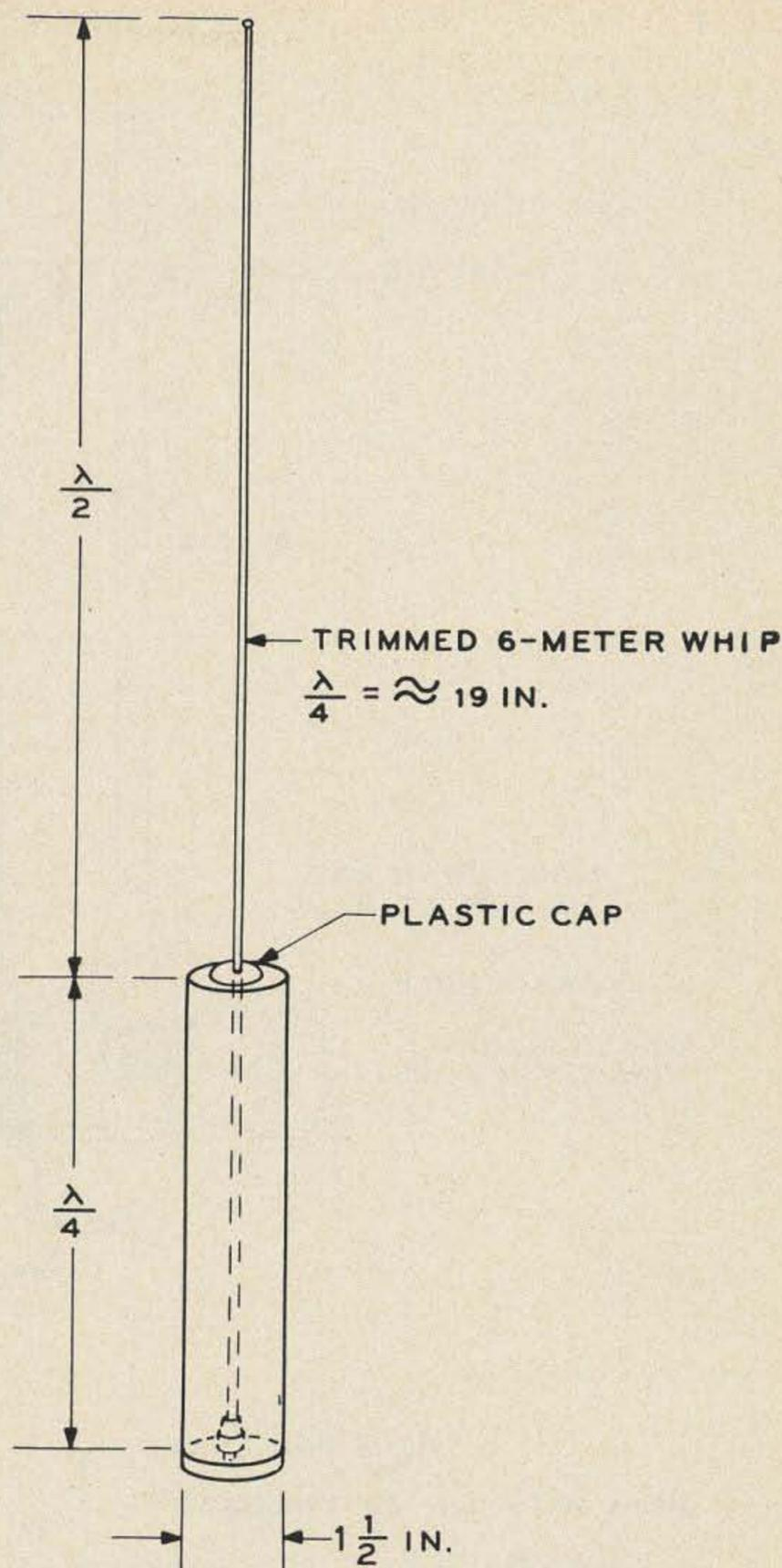
Fig. 2. The sewerpipe antenna.
